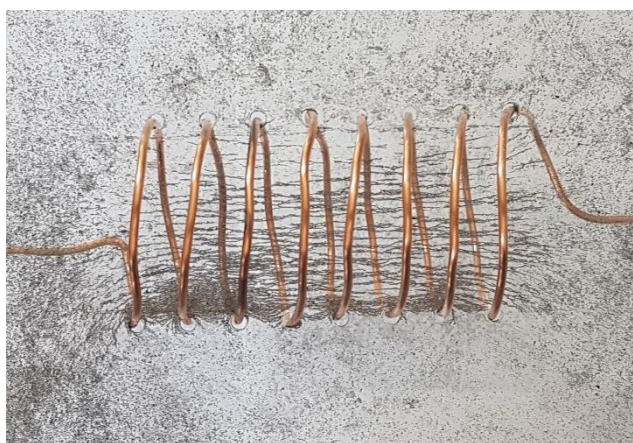
Slika 21 Silnice magnetskog polja dobivene pomoću željezne piljevine
