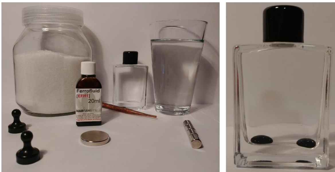
Slika 12 Pribor (lijevo), ferofluid u boci (desno)
