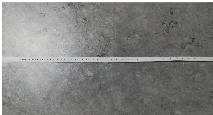
Slika 4.8: Primjer zapisa na trakici elektromagnetskog tipkala
