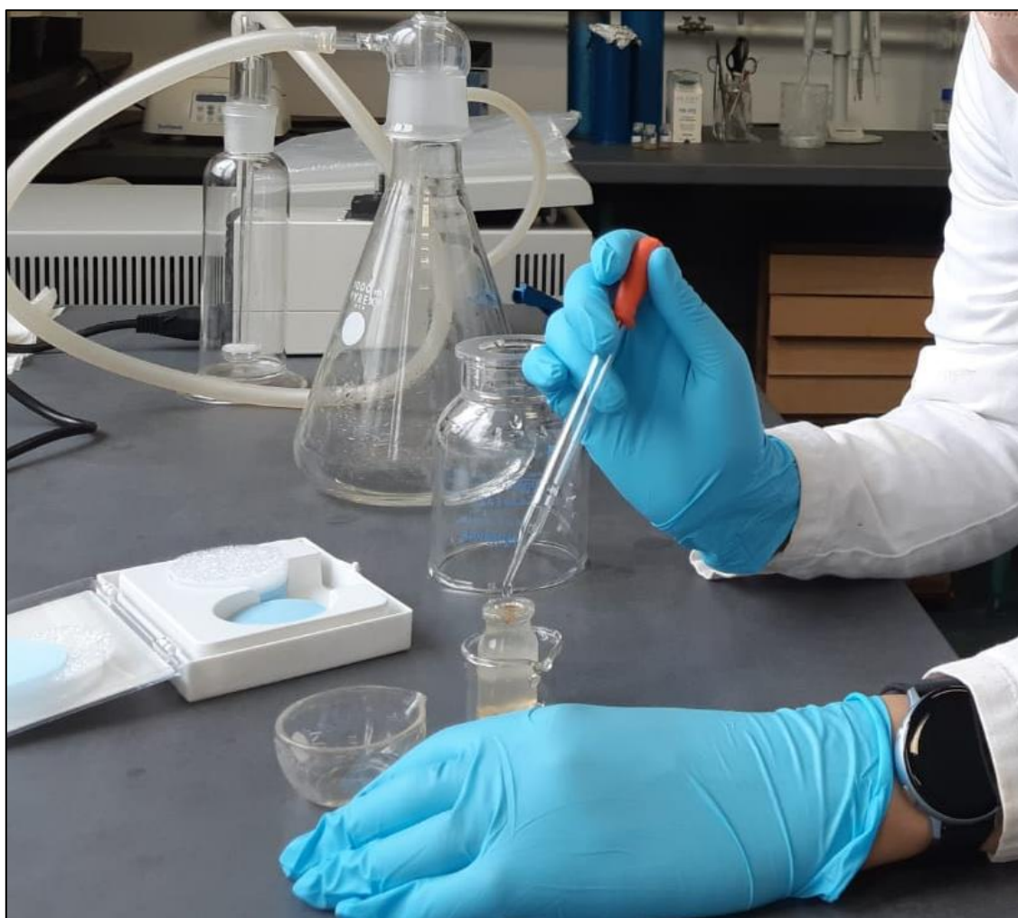
Slika 12. Dodavanje otopine NaBr ( \rho=1,266 g/mL) u uzorak. Foto: I. Grgić
