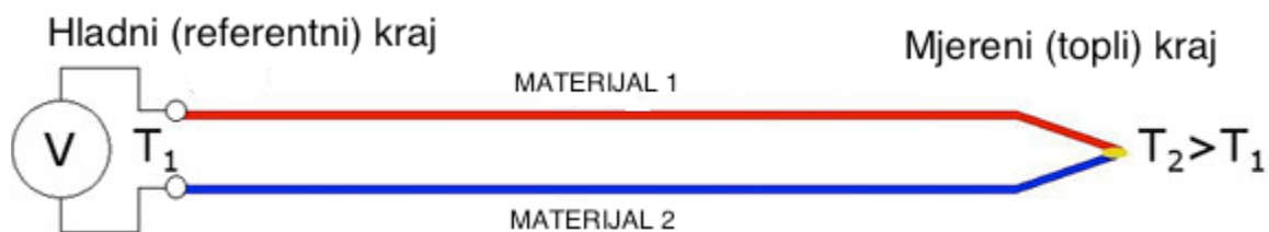
Slika 17: Princip rada termopara [5]
