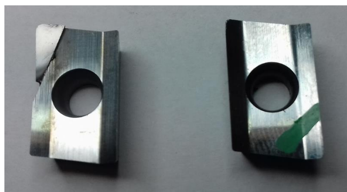
Slika 7.3 već izrađene nove rezne pločice s PKD materijalom
