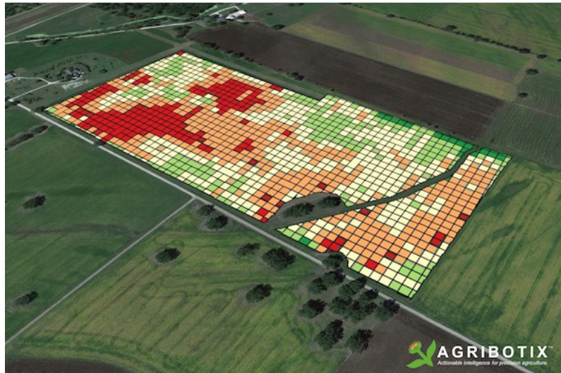
Slika 24: Mapiranje usjeva NIR filterom
