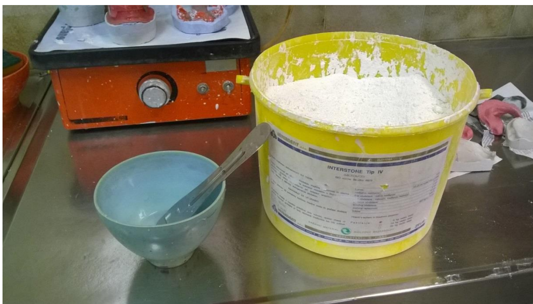
Slika 4.2. Gumena posuda sa ravnom inox-lopaticom za miješanje gipsa i pakiranje praha alabaster-gipsa
