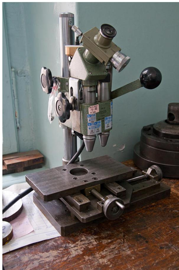
**Slika 41. Uređaj za mjerjenje tvrdoće Vickers metodom**
