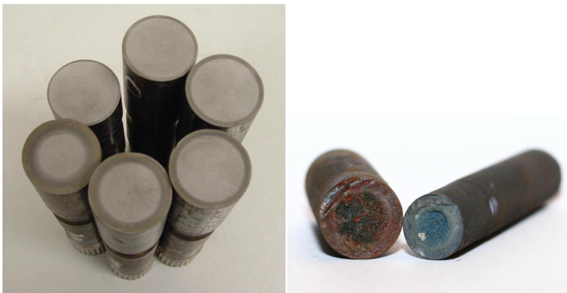
Slika 33. Probne epruvete za kontrolu pougljičavanja
