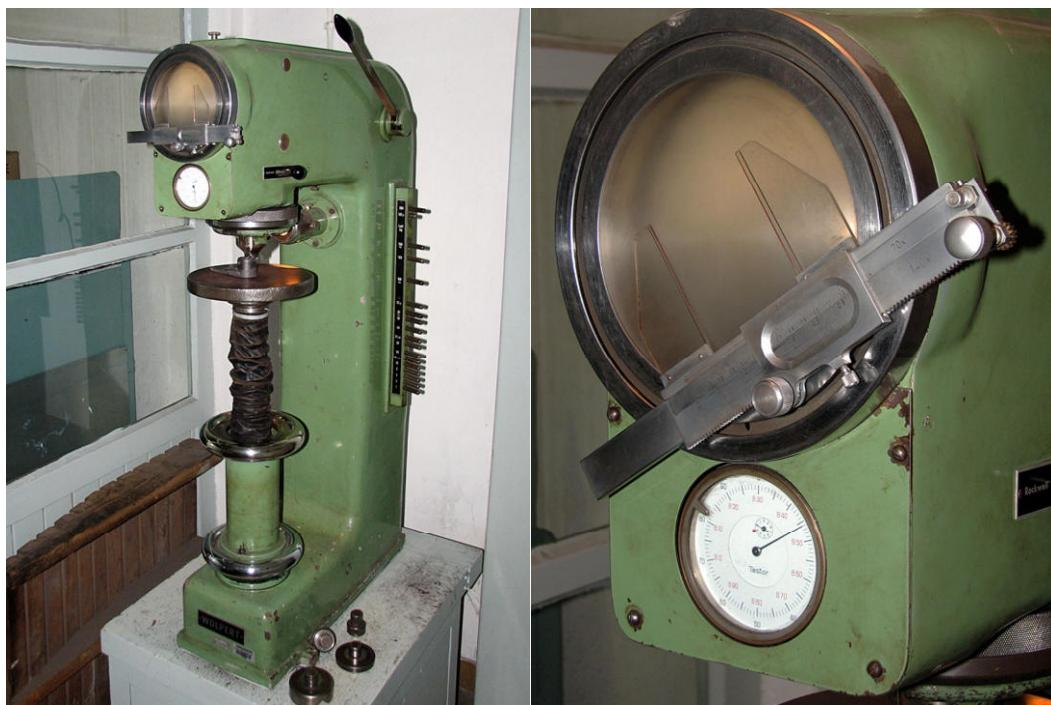
**Slika 38. Uređaj za mjerjenje tvrdoće Wolpert**
