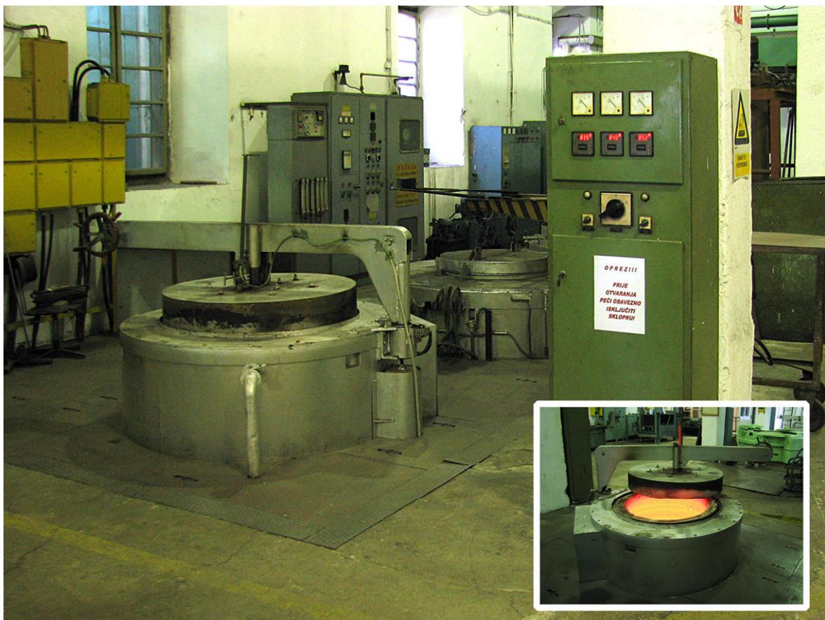
**Slika 21. Peć za zagrijavanje pougljičenih obradaka**
