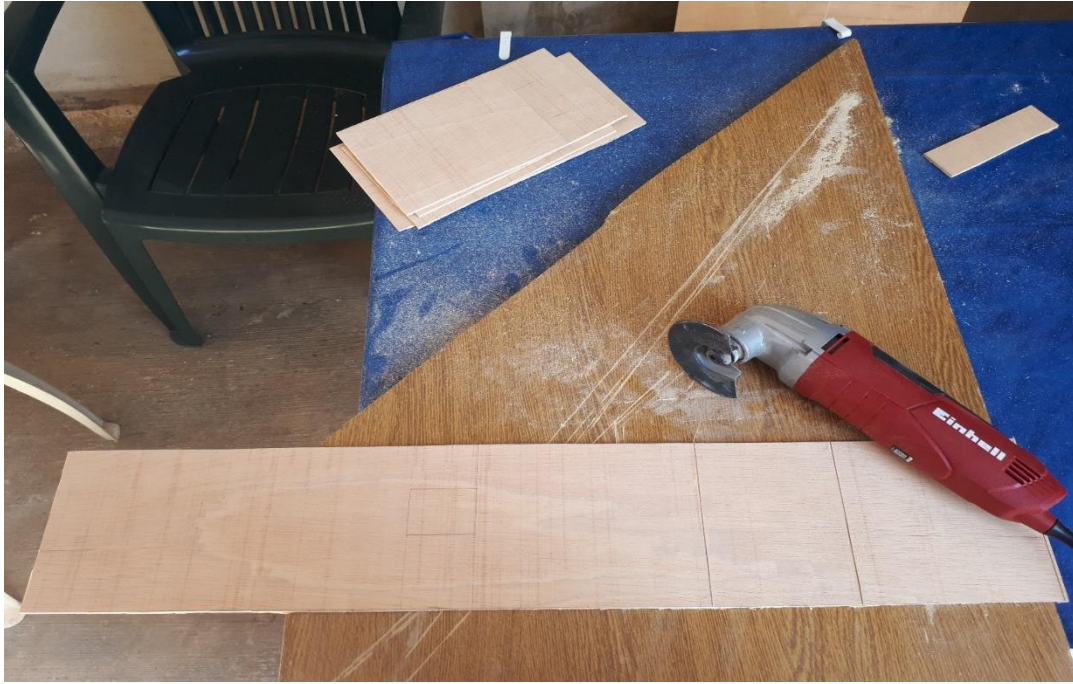
Slika 35. – Piljenje šperploče sa multifunkcijskim alatom
