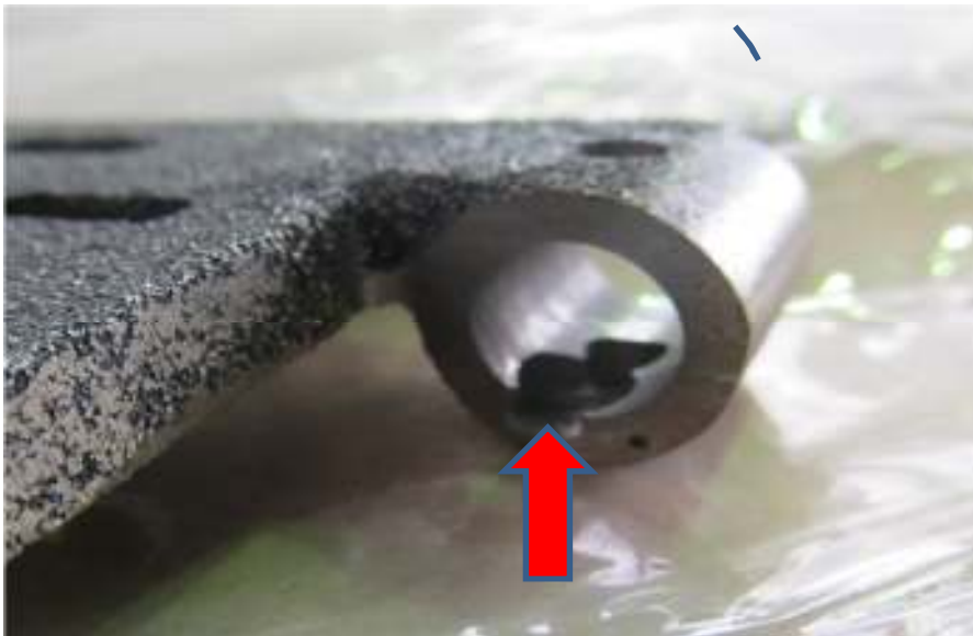
Slika 53. Pozicija sa greškom u ljevanju
