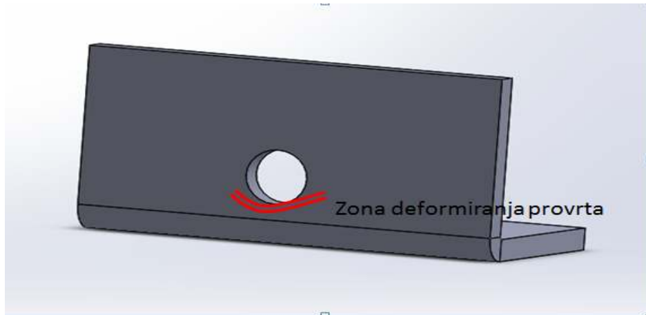
Slika 22. Prikaz provrta u zoni savijanja
