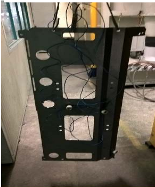
Slika 42. instrument za mjerenje temperatura na limu
