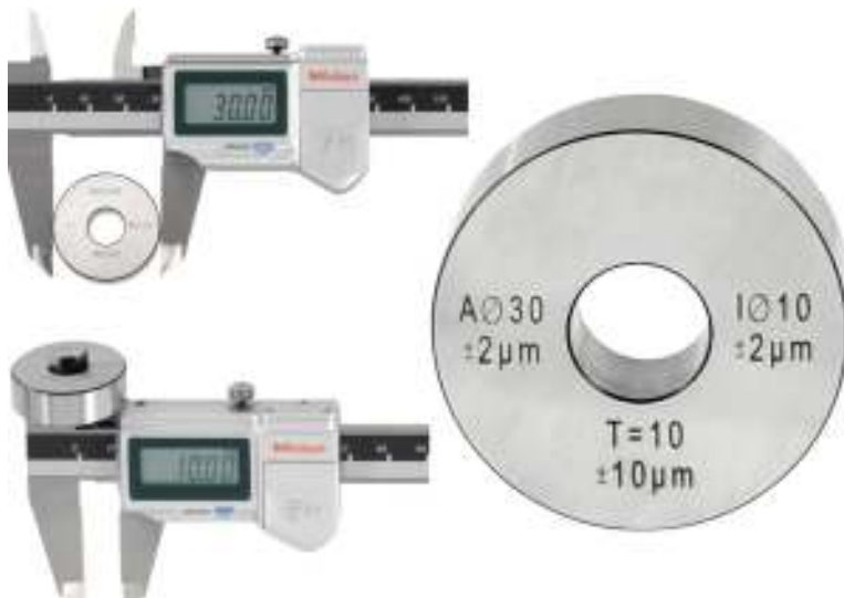
Slika 57. Prikaz kontrole pomičnog mjerila etalonom
