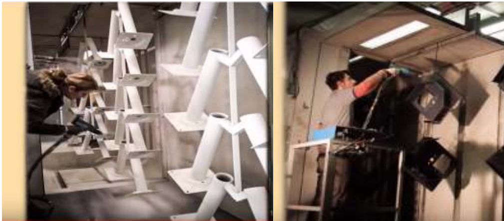
Slika 40. Ručno nanošenje praškaste boje
