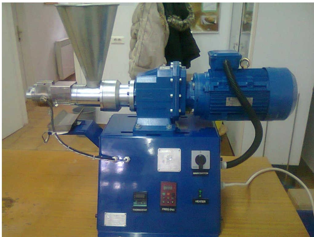
Slika 13 Laboratorijska kontinuirana pužna preša proizvođača ElektroMotor – Šimon d.o.o.
