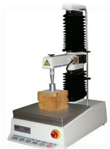
Slika 6. TA.XT Plus TextureAnalyzer
