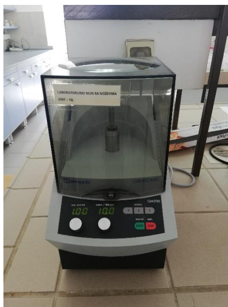
Slika 5. Laboratorijski mlin s noževima Grindomix GM200
