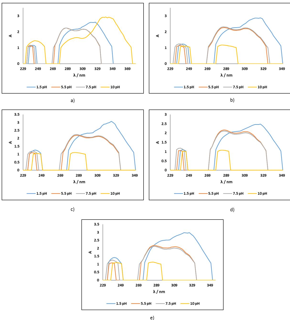
**Slika 7.** UV/Vis spektri modela kafeinske kiseline ( $25 \text{ mg L}^{-1}$ ) i  $\beta$ -glukana ( $5 \text{ mg L}^{-1}$ ) u različitim pH vrijednostima kroz vremenski period od a) 0h, b) 1h, c) 2h, d) 5h i e) 16h.
