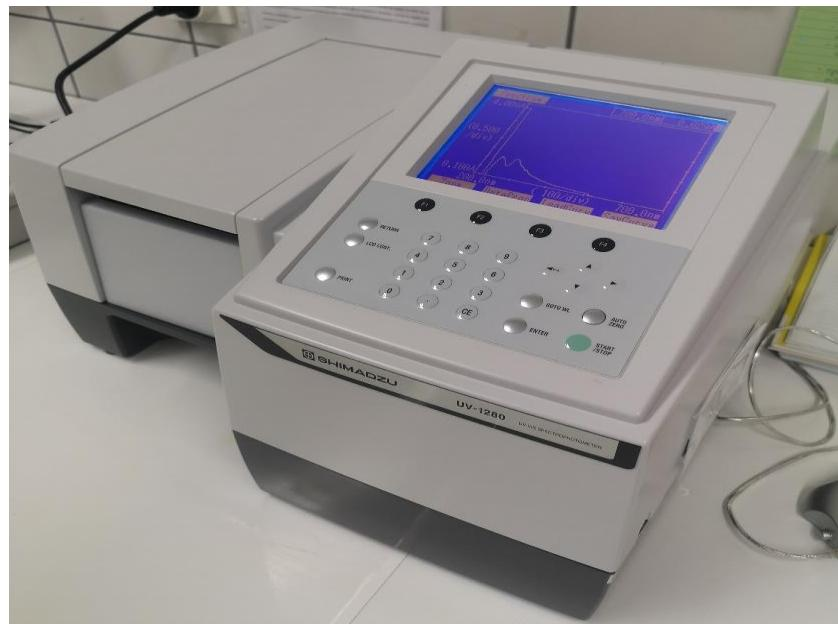
**Slika 4.** UV-1280 spektrofotometar
