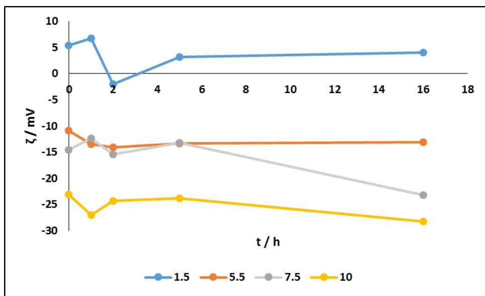
**Slika 10.** Ovisnost vrijednosti zeta-potencijala modela otopine kafeinske kiseline ( $25 \text{ mg L}^{-1}$ ) i  $\beta$ -glukana ( $5 \text{ mg L}^{-1}$ ) kroz vremenski period od 0h, 1h, 2h, 5h i 16h o različitim pH vrijednostima 1,5; 5,5; 7,5 i 10
