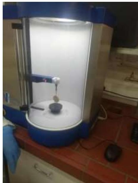
Slika 10: Uređaj za određivanje volumena Volscan profiler
