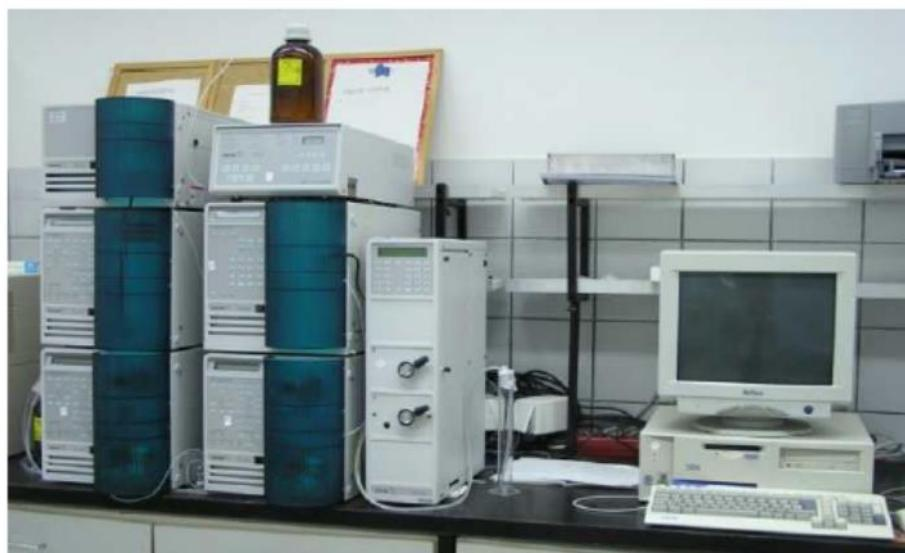
**Slika 11** HPLC analitički sustav
