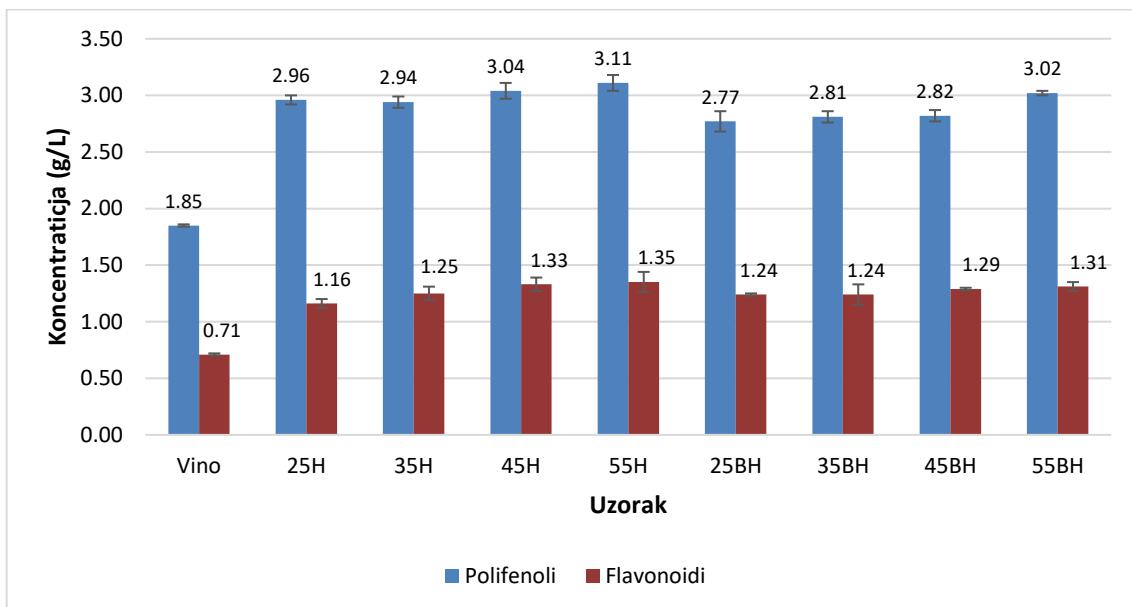
**Slika 12** Sadržaj polifenola i flavonoida u početnom uzorku vina Cabernet Sauvignon te koncentratima dobivenim procesom nanofiltracije pri tlaku 25, 35, 45 i 55 bara, s primjenom i bez primjene hlađenja
