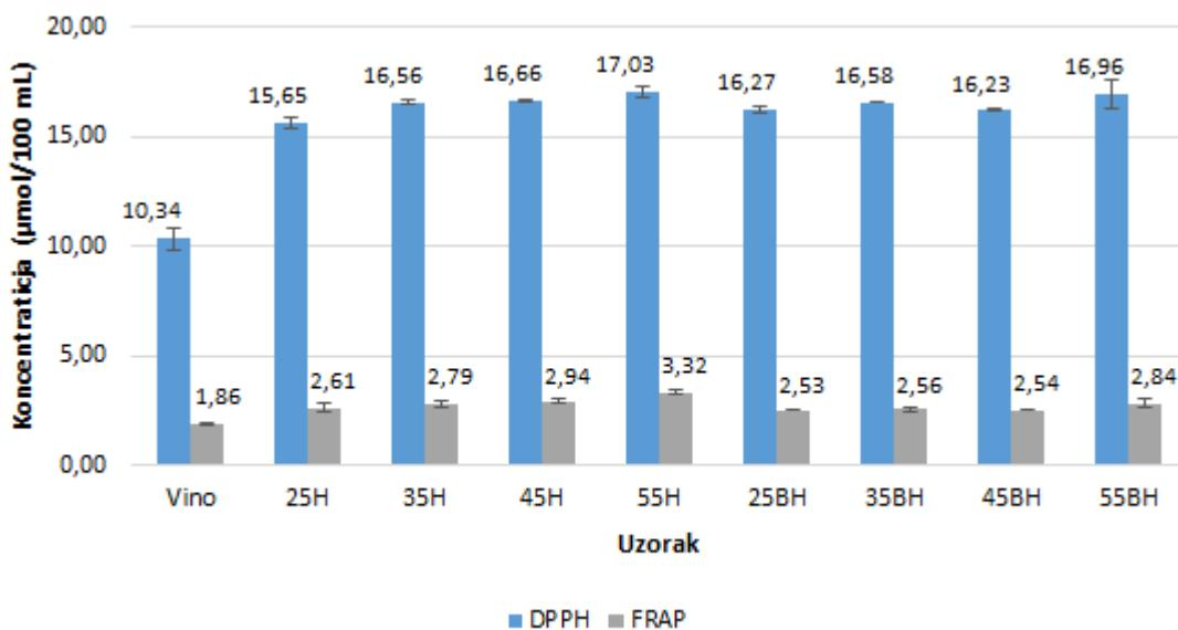
**Slika 14** Antioksidacijska aktivnost određena DPPH i FRAP metodom u početnom uzorku vina Cabernet Sauvignon te koncentratima dobivenim procesom nanofiltracije pri tlaku 25, 35, 45 i 55 bara, s primjenom i bez primjene hlađenja
