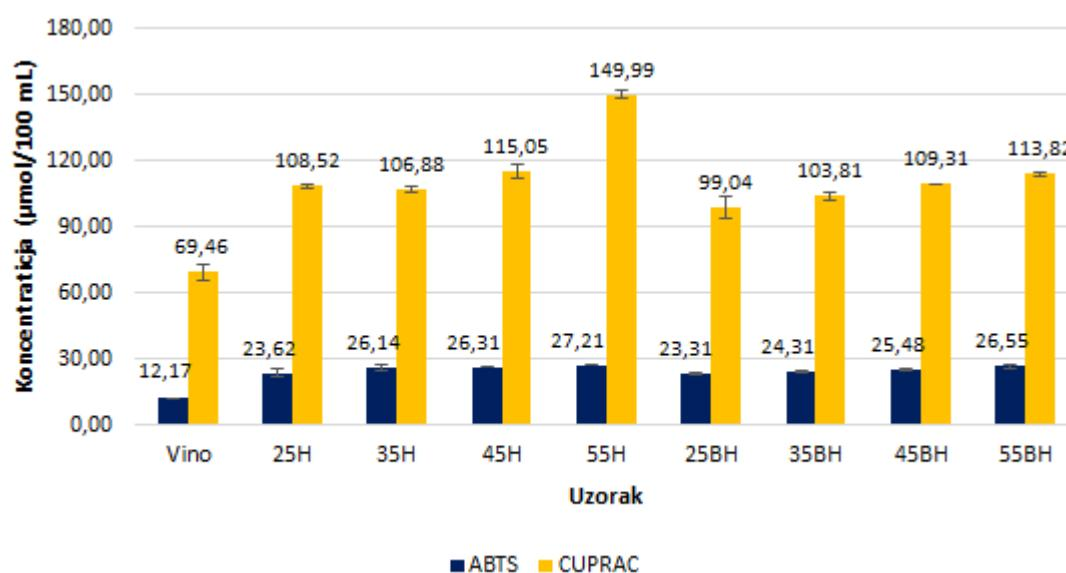
**Slika 15** Antioksidacijska aktivnost određena ABTS i CUPRAC metodom u početnom uzorku vina Cabernet Sauvignon te koncentratima dobivenim procesom nanofiltracije pri tlaku 25, 35, 45 i 55 bara, s primjenom i bez primjene hlađenja
