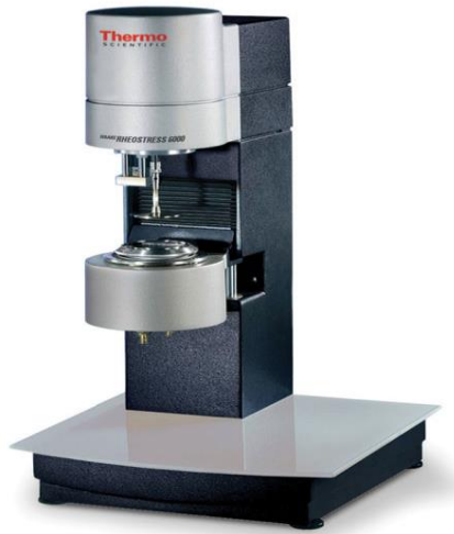
Slika 14 Uređaj za mjerenje viskoznosti RheoStress 600 (web izvor 8)
