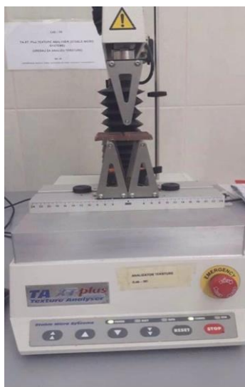
Slika 12 Određivanje tvrdoće čokolade na analizatoru TA.XT Texture Analyser
