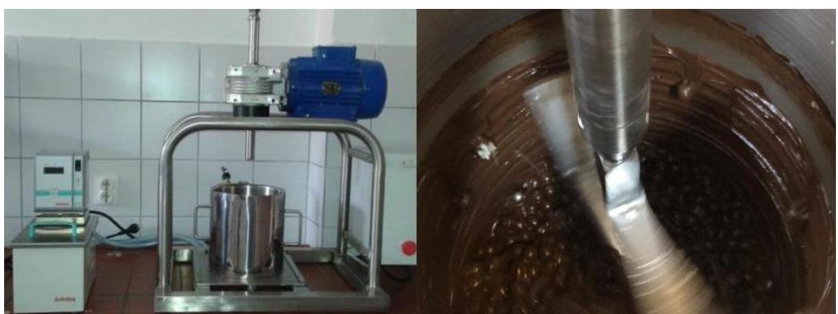
**Slika 18** Kuglični mlin
