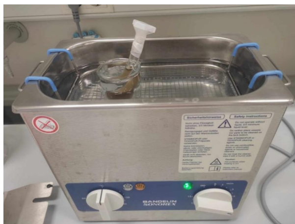
Slika 22 Ekstrakcija na ultrazvučnoj kupelji (Potočar, 2023)
