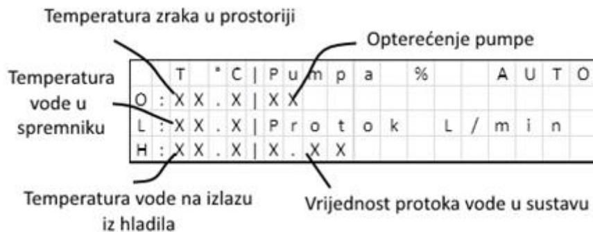
**Slika 18** Prikaz elemenata glavnog zaslonskog sučelja sustava za automatsko upravljanje
