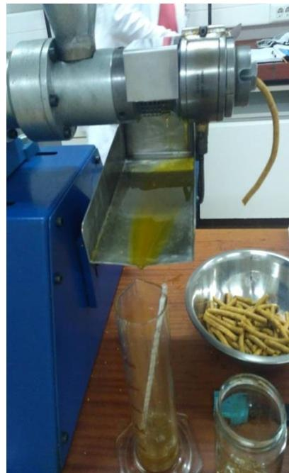
**Slika 11** Mjerenje volumena i temperature sirovog ulja
