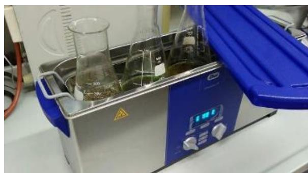
**Slika 9** Ultrazvučna kupelj
