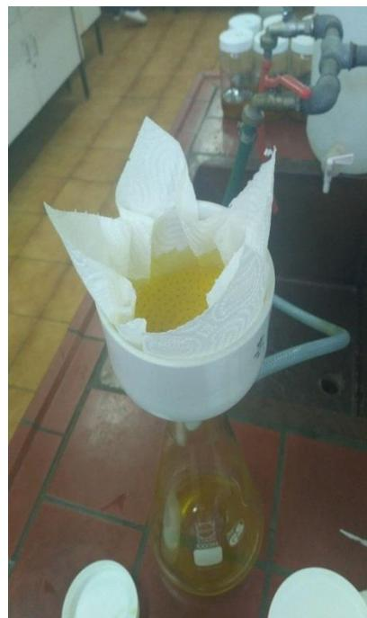
**Slika 12** Vakuum filtracija sirovog ulja preko Büchner-ovog lijevka
