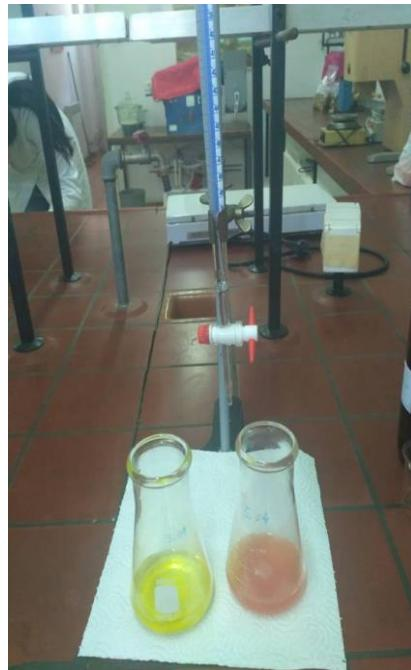
**Slika 14** Titracija ulja s NaOH
