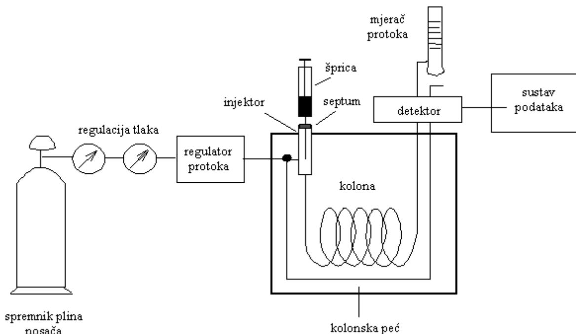
**Slika 9** Shematski prikaz plinskog kromatografa (izvor: web 4)
