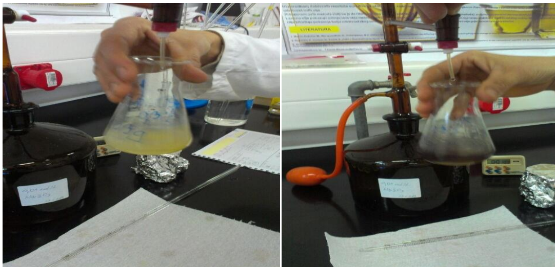
Slika 13 Promjena boje prilikom titracije određivanja peroksidnog broja
