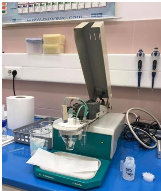
**Slika 5** Uređaj Computrace 757 VA za određivanje koncentracije arsena
