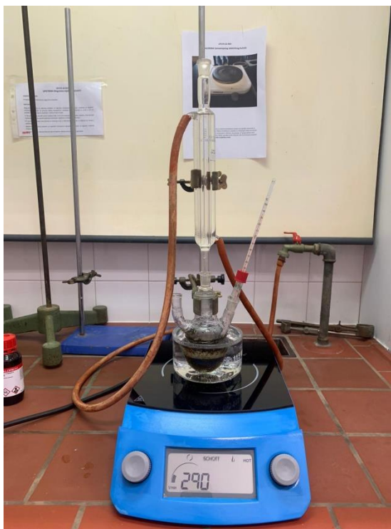
Slika 6: Aparatura korištena za kemijsku modifikaciju ljuske suncokreta
