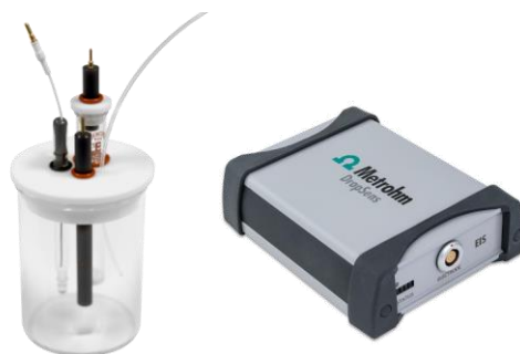
Slika 4 Potenciostat i troelektrodni sustav za provođenje elektrokemijskog mjerenja (WEB 4 i WEB 5)
