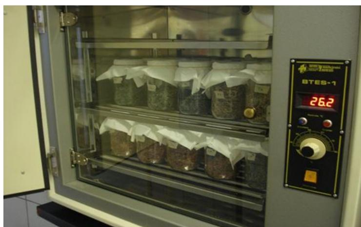
**Slika 11. Inkubator**
