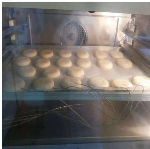
Slika 3 Prikaz postavljenih termoparova u čajna peciva
