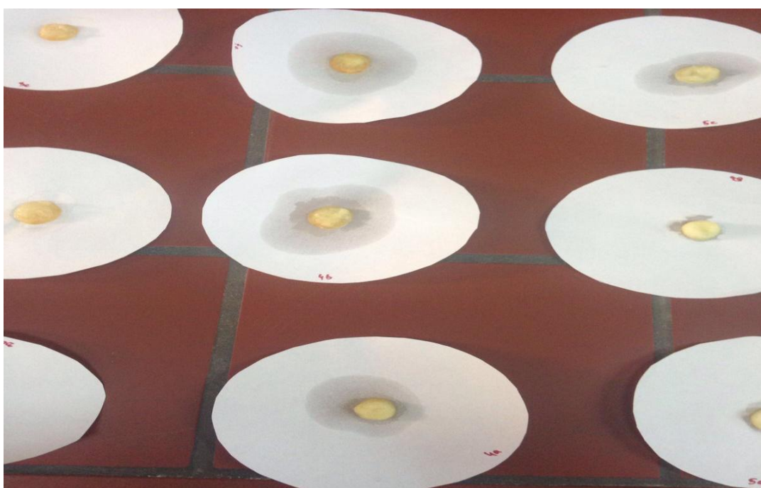
Slika 6 Otpuštanje ulja na filter papiru
