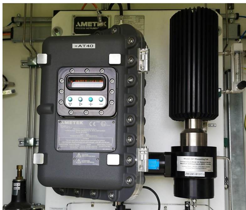
Slika 5-11. Ametek, analizator za mjerenje rosišta ugljikovodika
