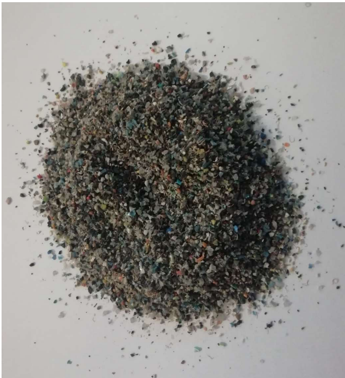
Slika 6-9 Usitnjeni kabeili (produkt reznog mlina)
