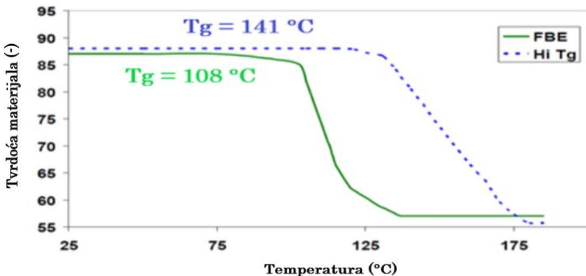
**Slika 4-1.** Temperatura stakla određena pomoću diferencijalne kalorimetrije skeniranja za fuzijski spojen epoksidni sloj (zeleno) i za materijal s visokom „temperaturom stakla“ (plavo) (Perez i ostali, 2008)
