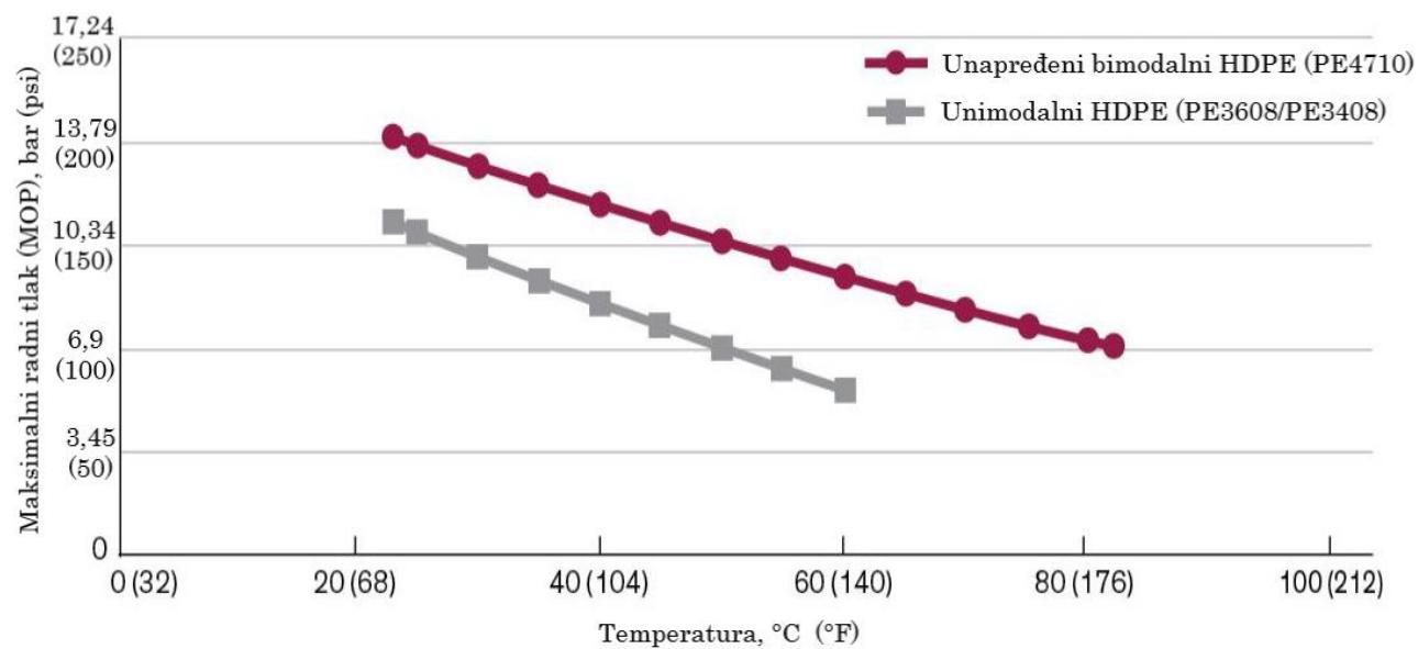
Slika 2-5. Ovisnost maksimalnog radnog tlaka o temperaturi za bimodalnu i unimodalnu HDPE cijev s koeficijentom SDR=11 (Chang i Baker, 2016)
