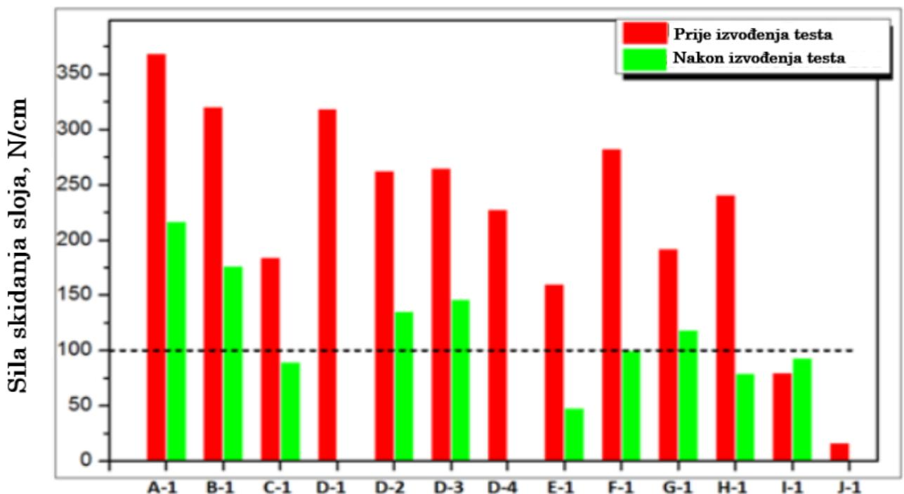
**Slika 4-3.** Usporedba sile koju je potrebno primijeniti za skidanje antikorozivnih presvlaka prije (crveno) i poslije (zeleno) izvođenja testa za uzorke polimernih traka različitih proizvođača (Feng i ostali, 2019)
