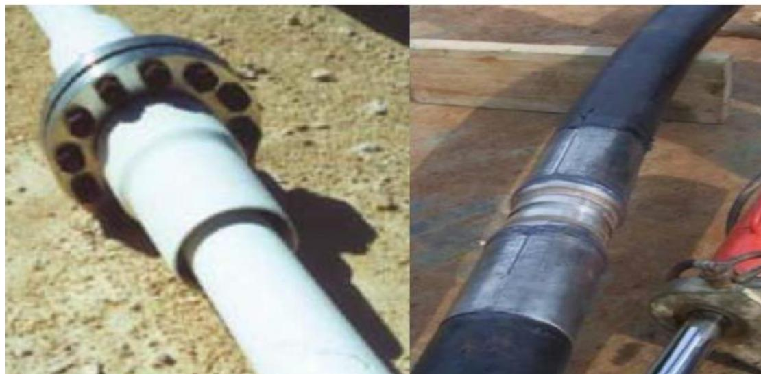
**Slika 3-4.** Spoj TCP izveden pomoću prirubnice (lijevo) i vrata za zavarivanje (desno) (Cheldi i ostali, 2019)
