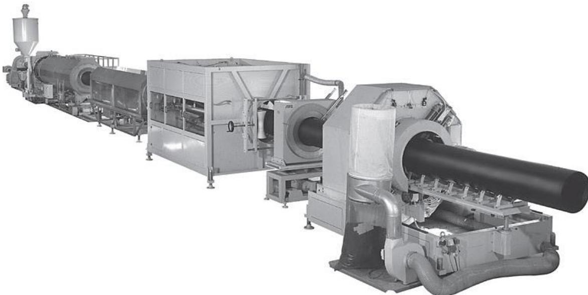
**Slika 2-2.** Ekstruder-stroj za izradu PE cijevi (PPI Handbook, 2008)
