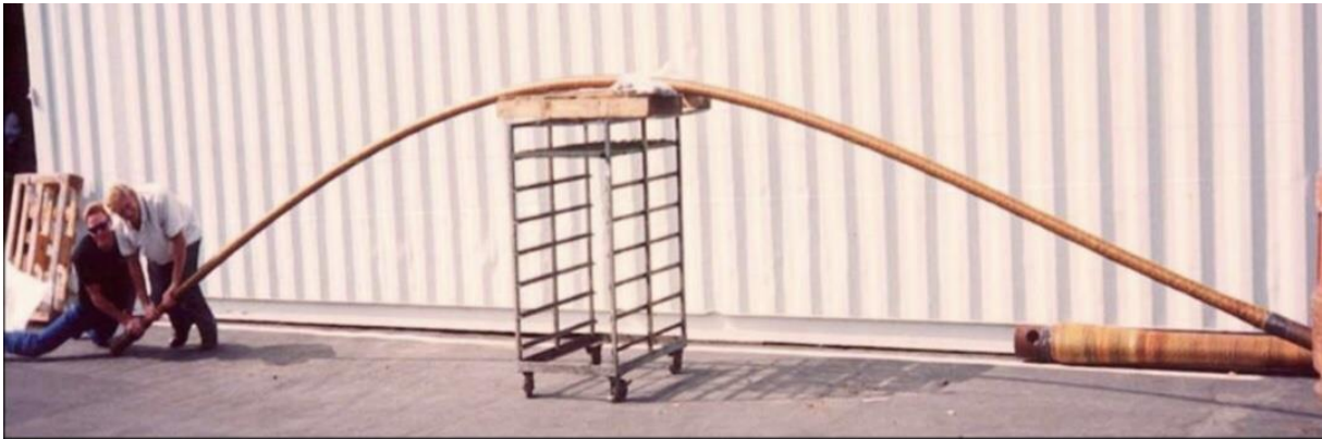
Slika 3-4. Fleksibilnost kompozitne bušaće šipke ( https://www.osti.gov/servlets/purl/1034754 )
