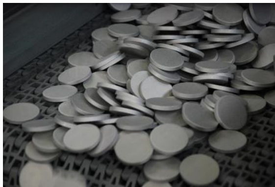
Slika 5-5. Površinsko obrađene rondelice (Talum (e), 2019)
