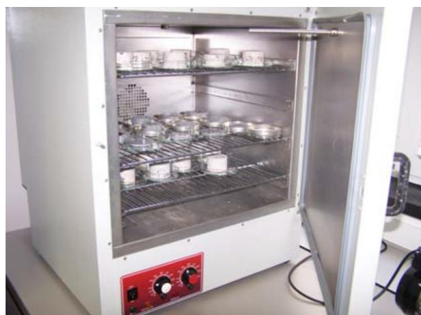
Slika 2-1 Sušionik za sušenje uzoraka (Briševac, 2012)
