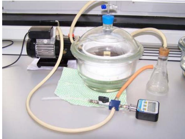
Slika 2-2 Oprema za saturaciju (Briševac, 2012)
