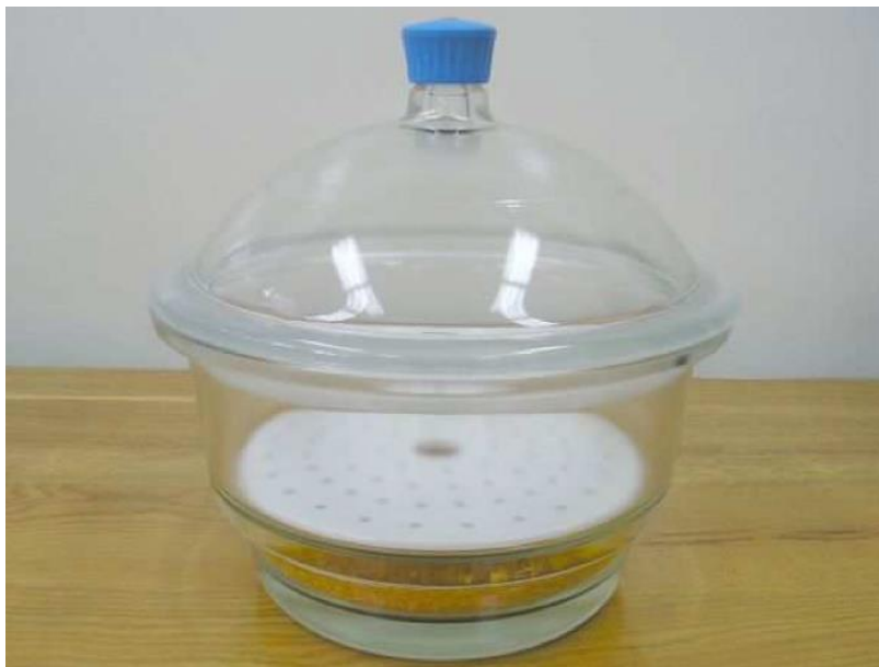
Slika 2-4 Eksikator (Hrženjak i Briševac, 2009)
