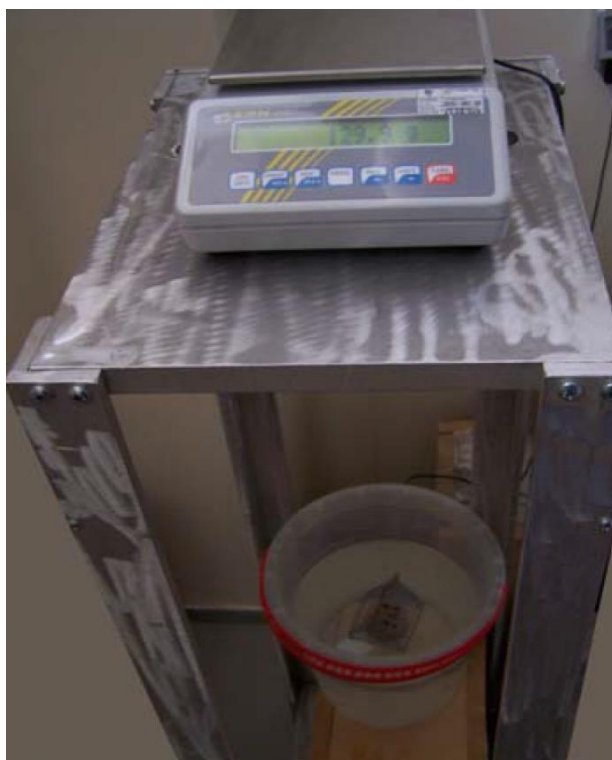
Slika 2-3 Vaga za mjerenje uronjene mase (Briševac, 2012)
