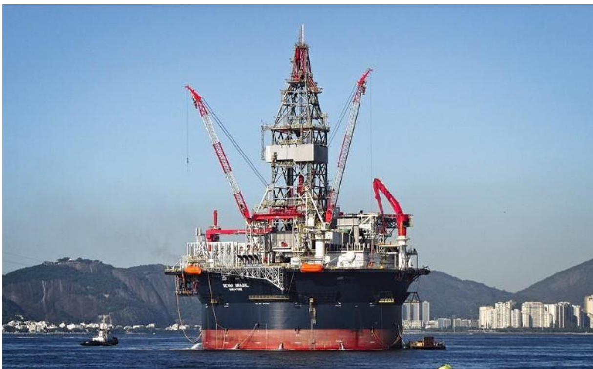
Slika 4-6. Poluuronjiva bušuća platforma kružnog oblika (www.marinetraffic.com, 2020)
