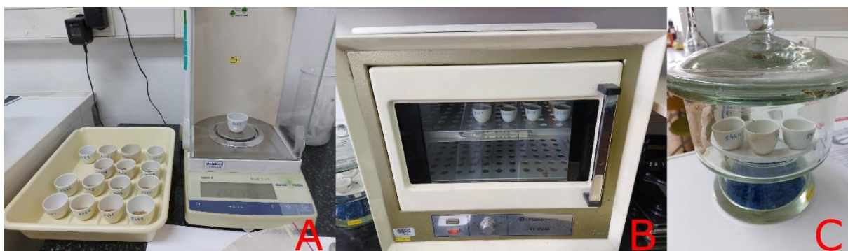
Slika 3-7. Određivanje udjela vlage u uzorcima, A) Vaganje uzoraka, B) Sušenje uzoraka, C) Uzorci u desikatoru spremni za ponovno vaganje
