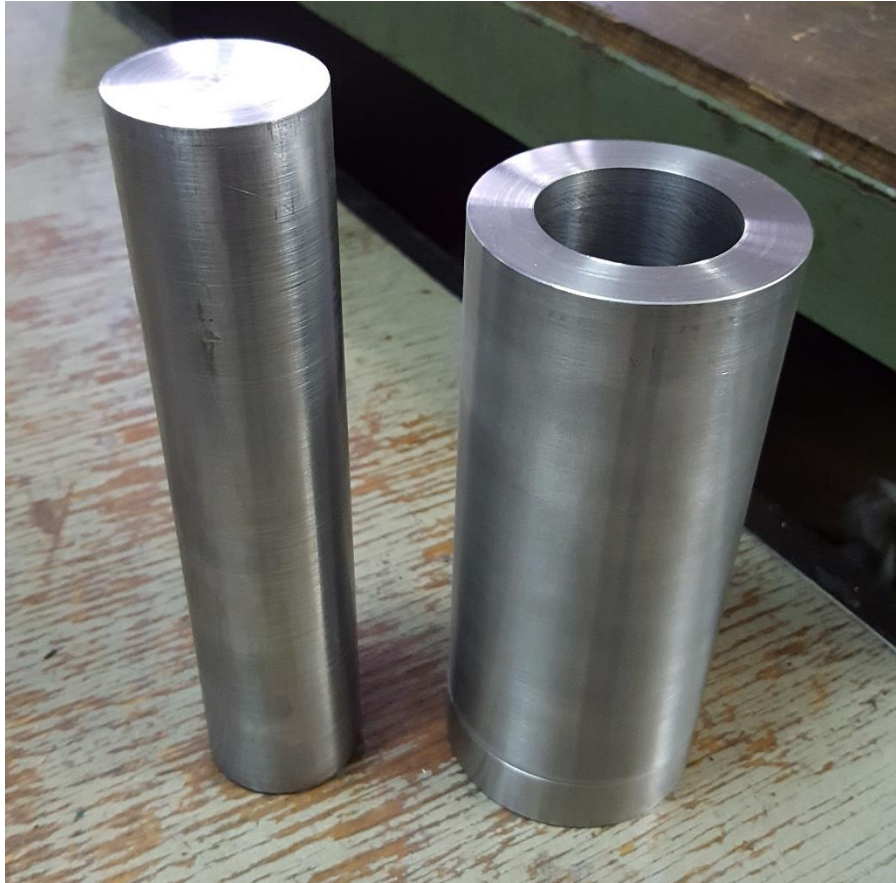
Slika 4-2. Kalup 1, cilindar (lijevo) i plašt (desno).
