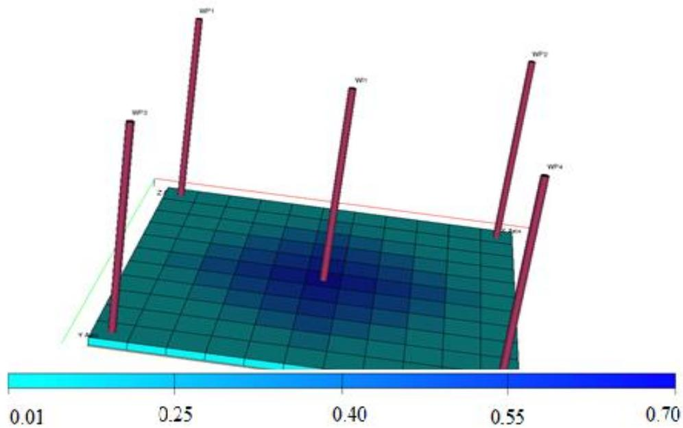
Slika 7-5. Zasićenje vodom u trenutku pojave inerferencije
