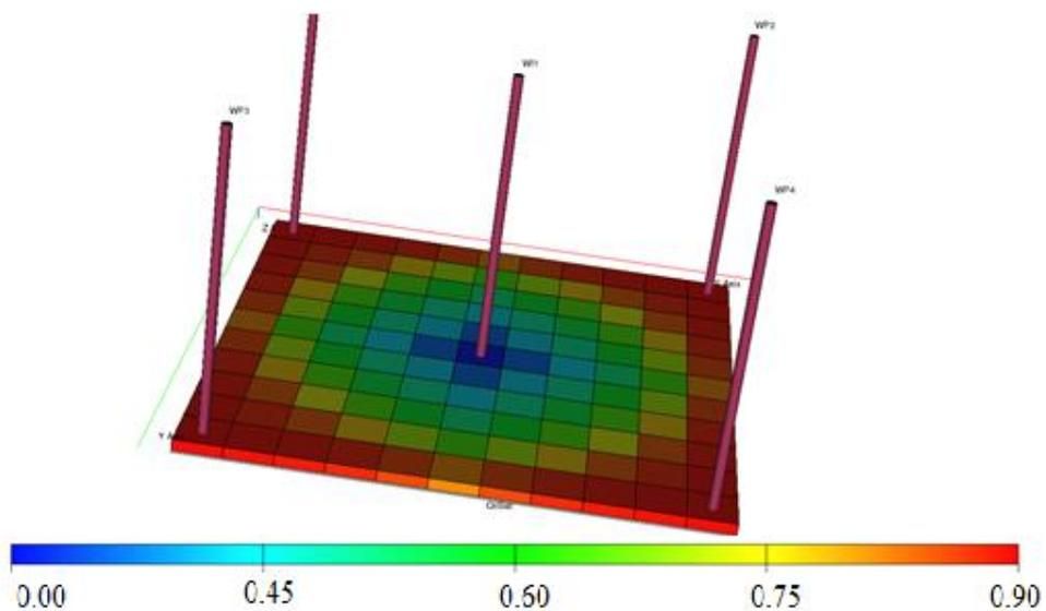
Slika 7-11. Zasićenje naftom u trenutku istiskivanja plina vodom
