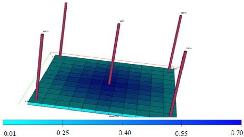
Slika 7-7. Zasićenje vodom u trenutku istiskivanja plina iz pornog prostora
