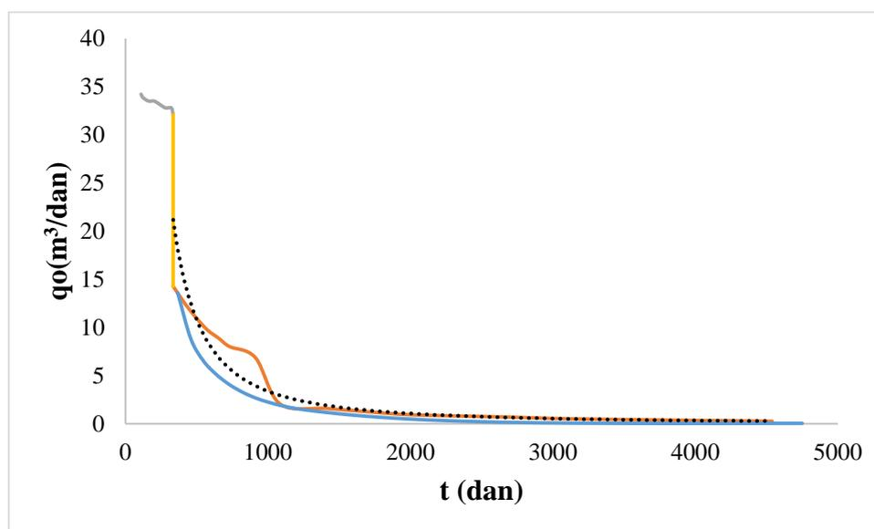
Slika 6-9. Trenutna proizvodnja nafte (3. slučaj – treći simulacijski model)
