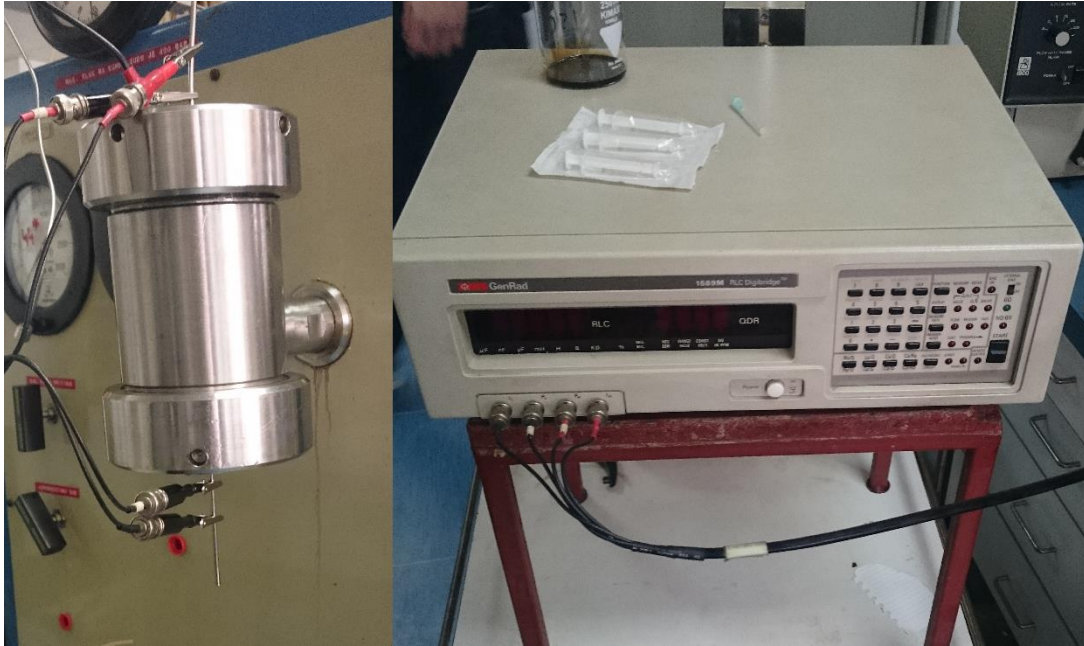
Slika 5-2. Oprema za mjerenje otpora jezgre.
