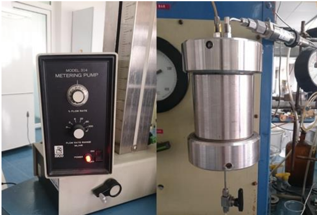
Slika 3-2. Visokotlačna pumpa i triaksijalni držač jezgre.
