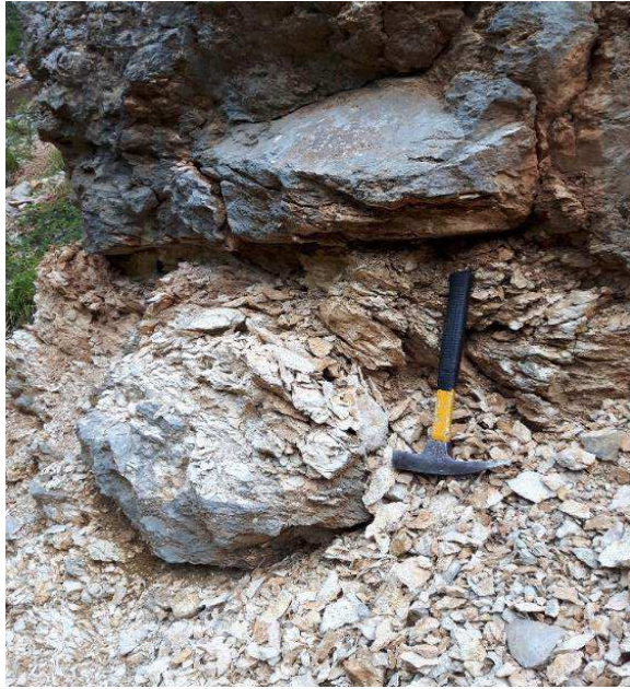
Slika 5-30. Rasjedna ploha orijentacije R_p=310/20 na točki Z 67 .
