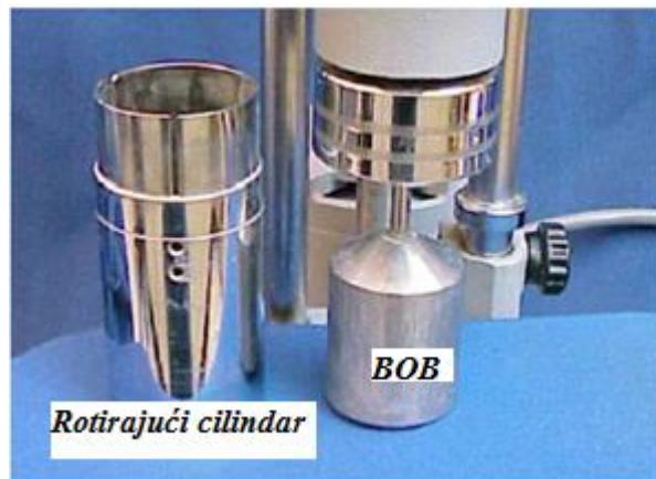
Slika 3-3. Dijelovi Fann viskozimetra (Olowolagba i Brenneis, 2010)
