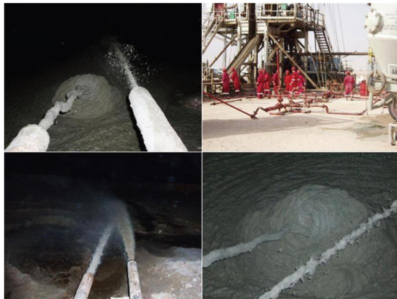
Slika 5-24. Prikaz slika postrojenja i povrata pjenocementne kaše na površinu (Weerd i dr., 2010)
