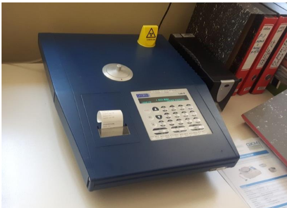
Slika 4-3 Uređaj „Oxford Analytical LabX-3500 OI“
