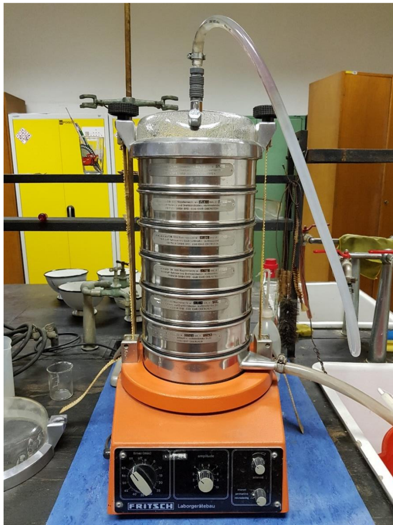
Slika 4-1 Vibracijsko sito „FRITSCH – Analysette 3“
