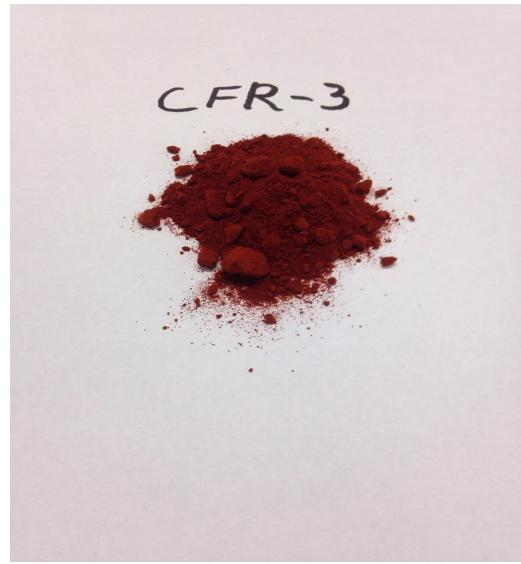
Slika 5-2. Dispergator CFR-3 kompanije Halliburton
