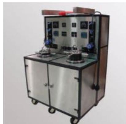
Slika 4-4. Autoklav - komora za stvrđnjavanje
