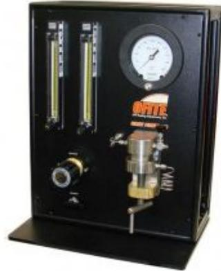
Slika 4-7. Uredaj za mjerjenje propusnosti cementnog kamenja (OFI Testing Equipment, 2018 (a))
