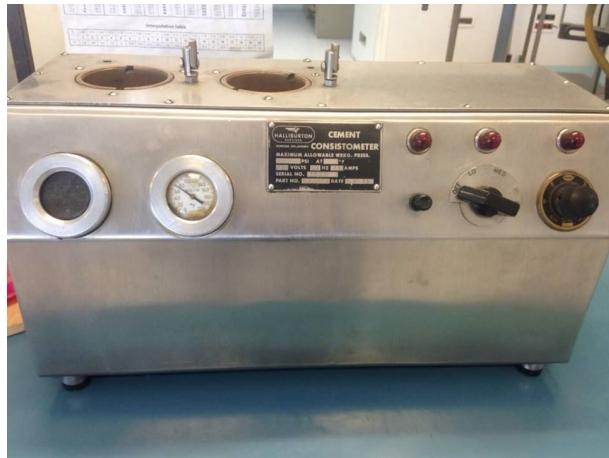
Slika 5-8. Atmosferski konzistometar
