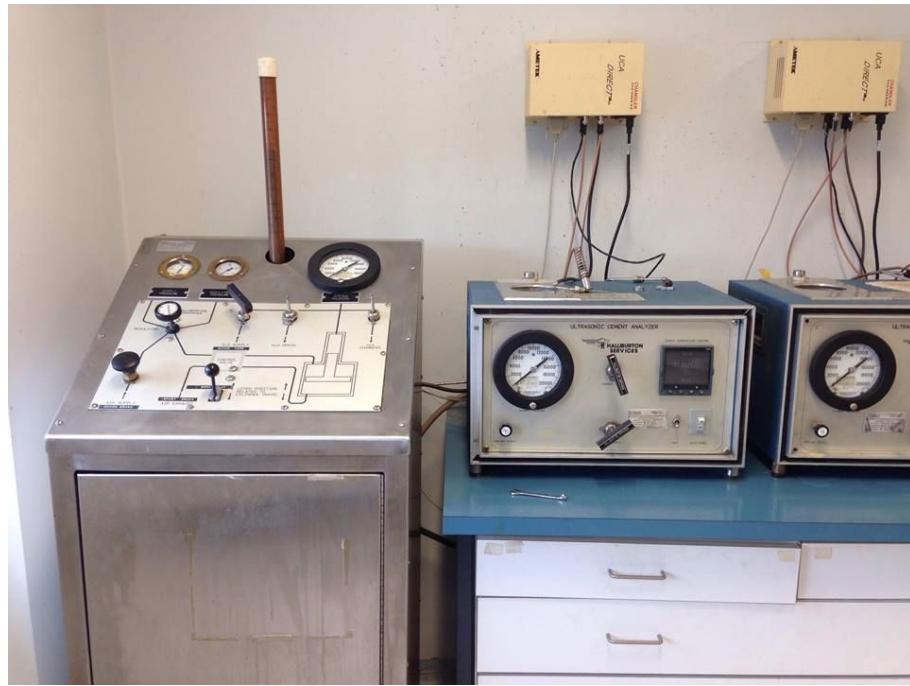
Slika 5-14. Ultrazvučni analizator (UCA) korišten u radu
