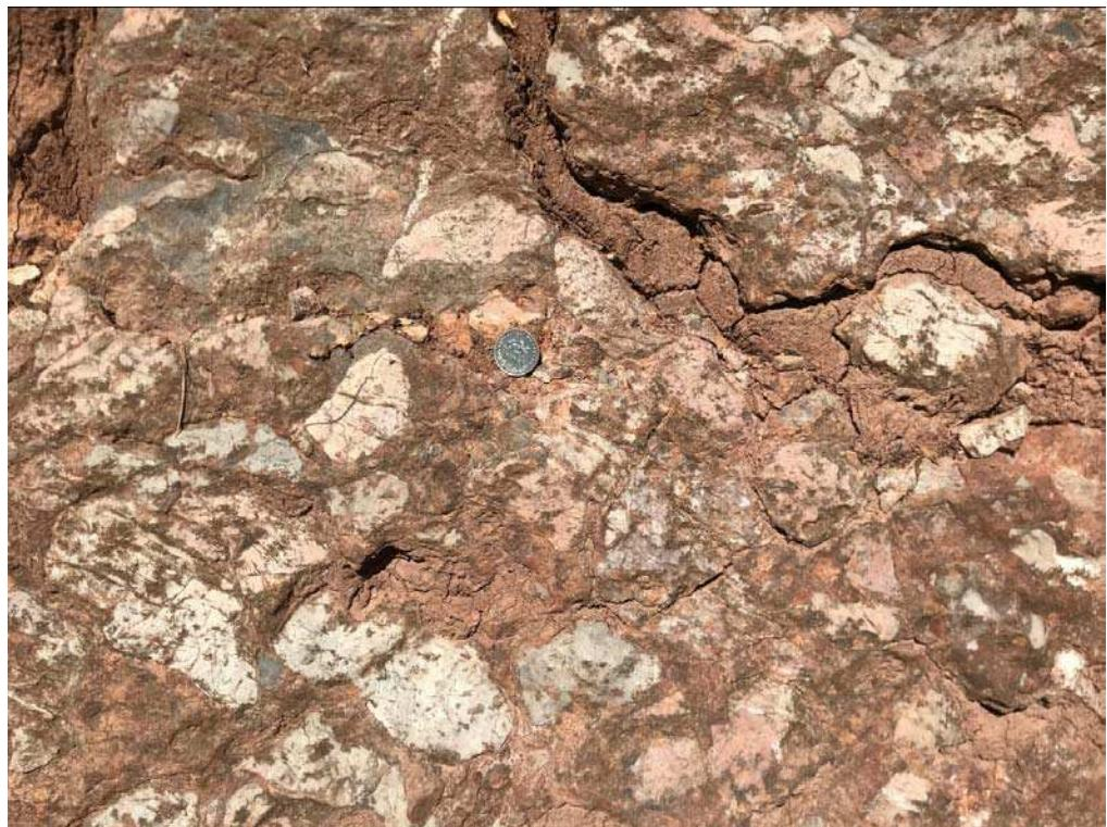
*Slika 4.12. Oligomiktni konglomerati (uzorak Klementa 1)*
