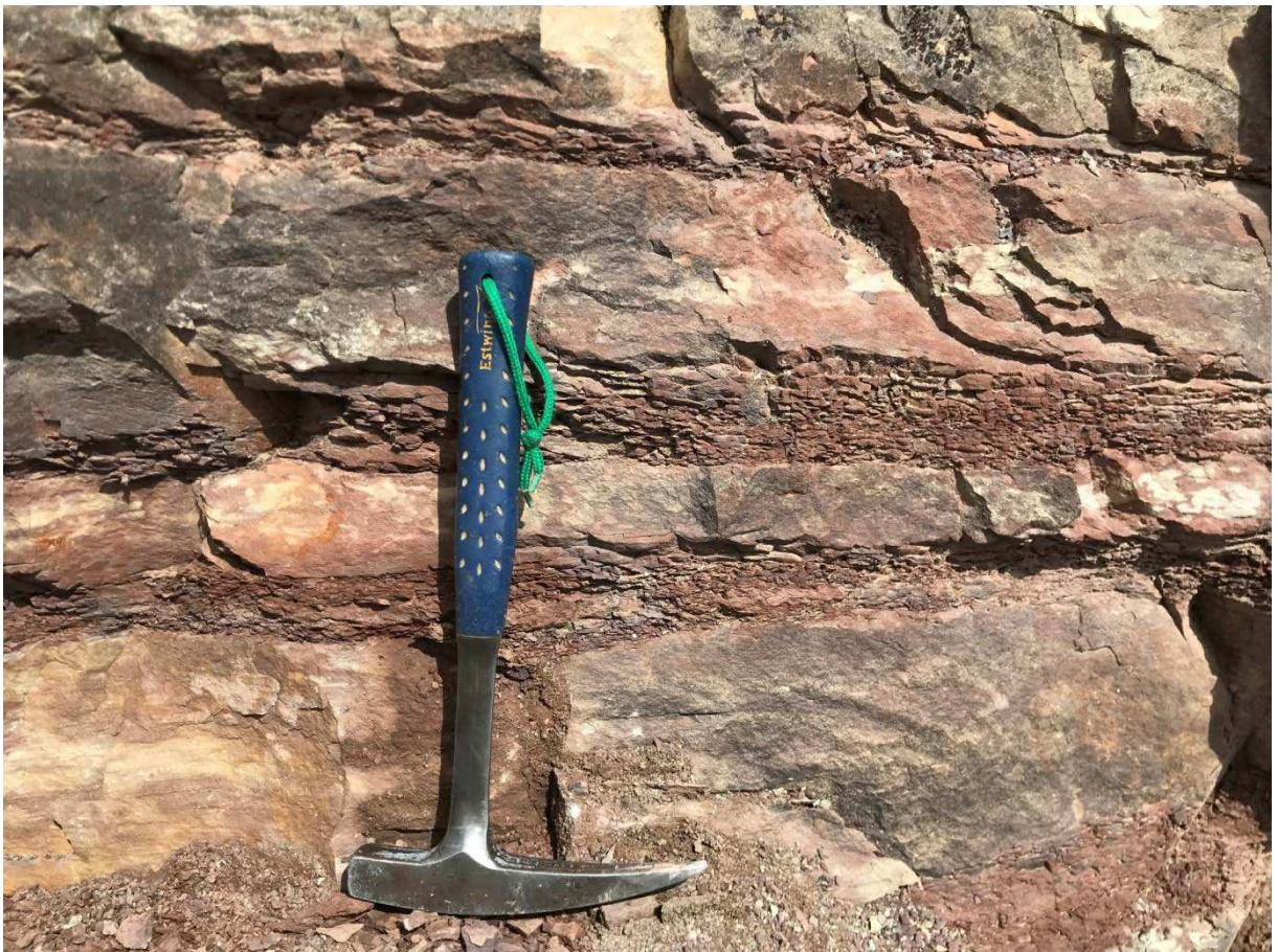
Slika 4.6. Sloj 2 stupa C. Izmjena pješčenjaka i pelita.
