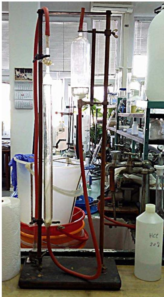
Slika 3.5. Aparatura korištena za određivanje udjela  $\text{CaCO}_3$  po metodi kalcimetrije.
