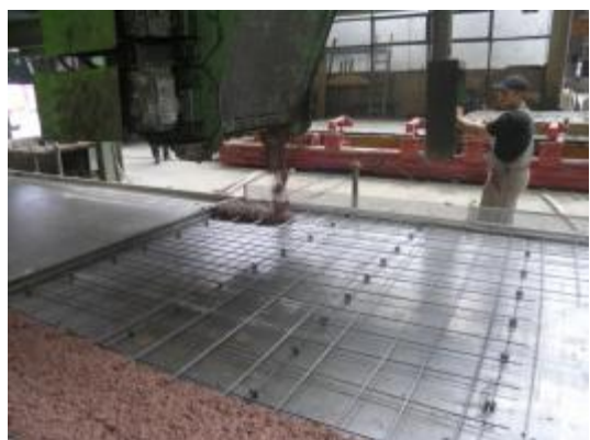
Slika 4-9: Izrada vanjskog sloja eco-sandwich ploče (ECO-SANDWICH, 2015)
