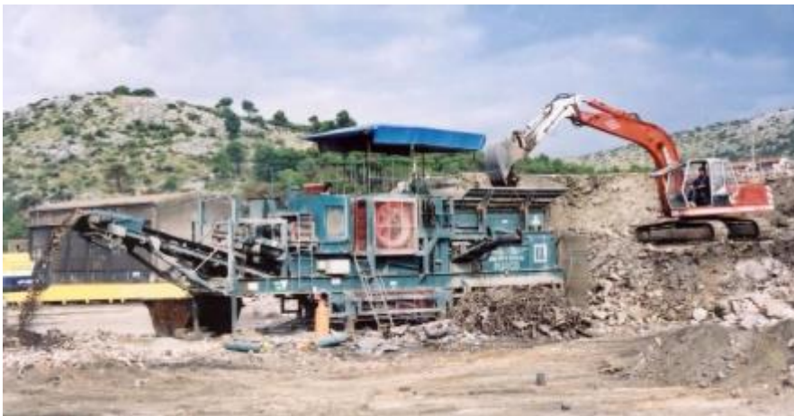
Slika 4-2: Usitnjavanje u mobilnom drobilničnom postrojenju (Lovinčić, 2018)
