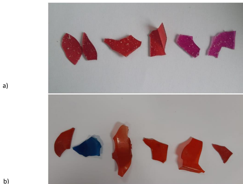
Slika 5-3. Usporedba plastike a) prije atricijskog čišćenja b) poslije atricijskog čišćenja
