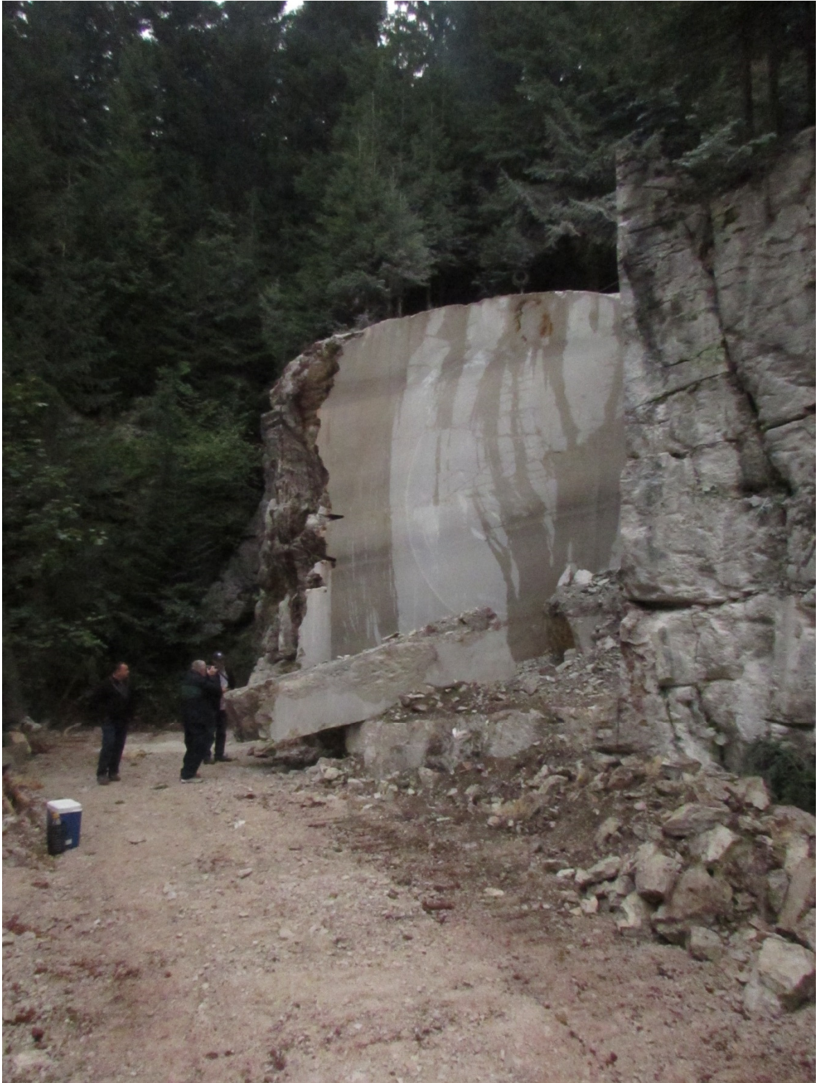
Slika 5-5. Zasjek u donjokrednim vapnencima koji stratigrafski predstavljaju podinu boksita, a potencijalno su zanimljivi kao arhitektonsko-građevni kamen.
