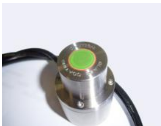
Slika 4-4: MTPS senzor. Preuzeto s
