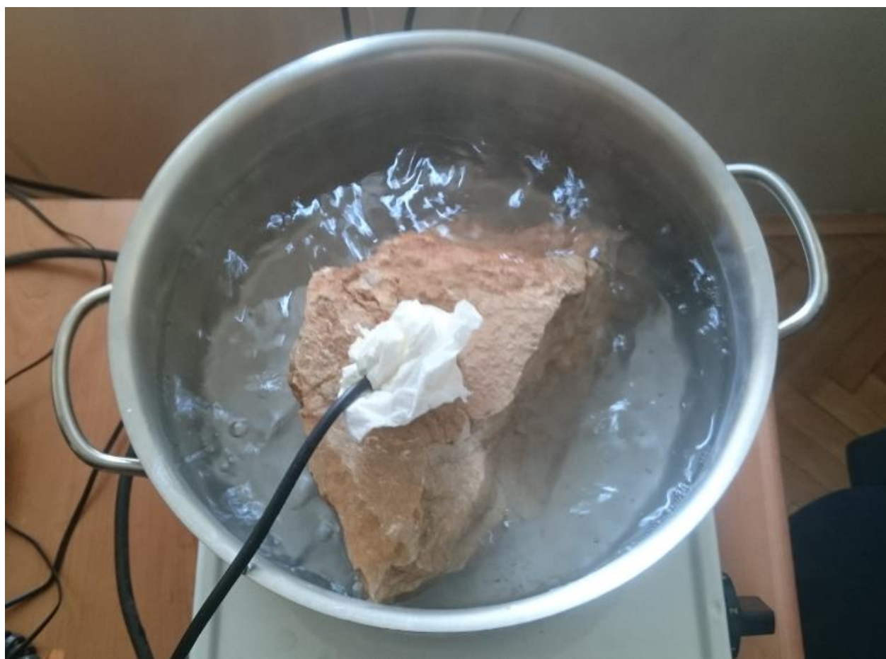
Slika 6-5: Mjerenje temperature na načelu grijanja vode do kipljenja na uzorku br. 2
