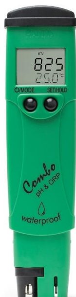
Slika 4.2. Instrument korišten za određivanje pH i ORP-a
