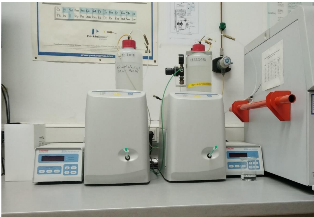
Slika 4.3. Ionski kromatograf na Rudarsko-geološko-naftnom fakultetu u Zagrebu
